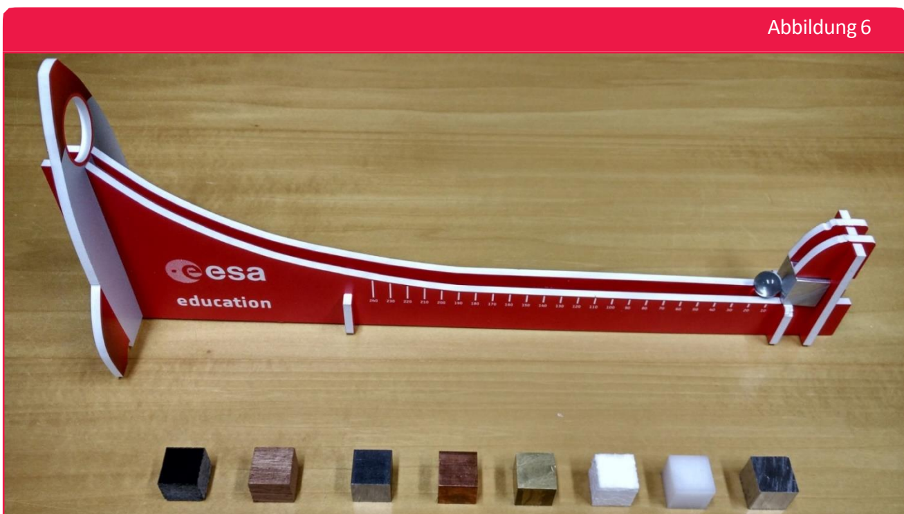
↑ Aufbau für den Widerstandstest
